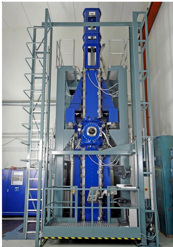
Abbildung 3: oben) Foto der Kristallzieherei in Pretzfeld um 1955 mit Anlagen zur Einkristall-Herstellung durch des tiegelfreie Zonenziehen. Quelle: Festschrift anlässlich des 60. Geburtstages von Eberhard Spenke, 1965. unten) Foto einer heutigen Anlage für das tiegelfreie Zonenziehen. Quelle: PVA Crystal Growing Systems GmbH.
